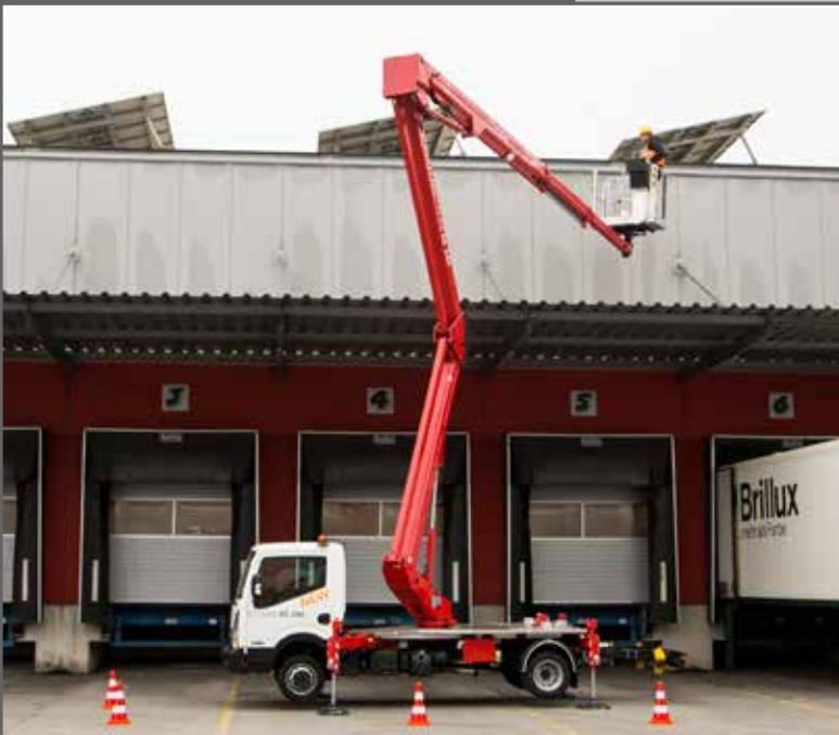
Mit der ECOLINE RS 240 können herausragende **24 Meter Arbeitshöhe** erreicht werden. Die Gelenk-Teleskop-Bühne bietet in der „**low budget**“-Angebotsreihe enorme Anwendungsflexibilität und -möglichkeiten. Seit Einführung im Frühjahr 2017 erfreut sie sich großer Beliebtheit.
